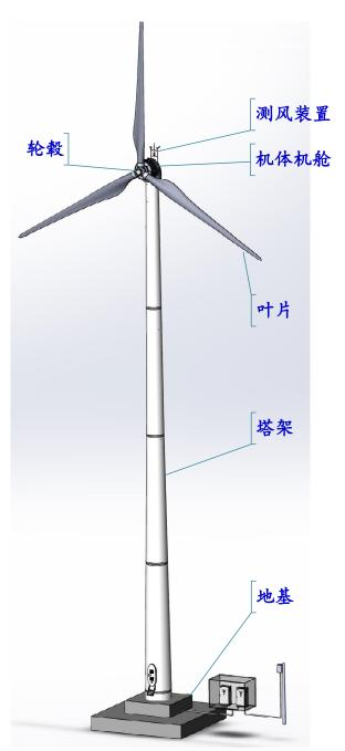
图 1 GP25 风力发电机系统 机组主要部件示意
